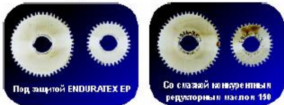
ENDURATEX снижает отложение шлама и лака до минимума, надежно защищая редукторы и подшипники.
